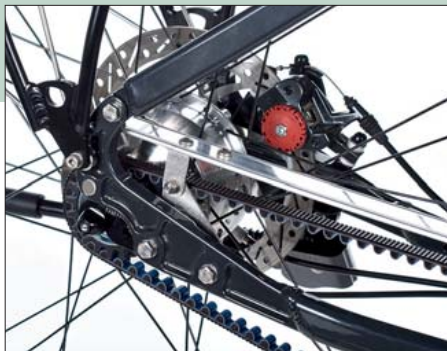
Die Schlüsselstelle: Das Ausfallende mitsamt teilbarer Sitzstrebe und Achs-Spannvorrichtung beanspruchte lange Reifezeit. Umso besser ist es gelungen.
